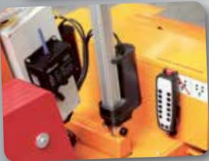
Der Lifter ist optional mit Funksteuerung für die Drehfunktion des Jochs sowie für die übrigen Funktionen des Lifters lieferbar.
