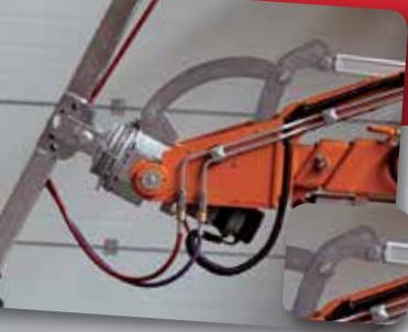
Der Hebekopf hat zwei Einstellmöglichkeiten, durch zwei Löcher für den Sicherungsbolzen. Dadurch lässt sich der Kippwinkel nach oben oder unten erhöhen.
