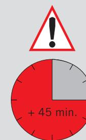
Bei Einhängen der Tür innerhalb von 45 Min. nach Erreichen der Montagefähigkeit empfehlen wir sicherzustellen, dass die Rollenwagen bis zum Ablauf dieser 45 Min. keinen schlagartigen Belastungen ausgesetzt werden.
