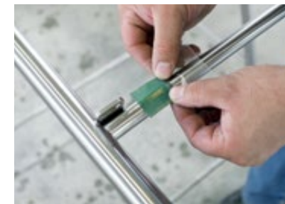
Nach dem Vliesen wird das MWE-Logo auf die Strebe geätzt.
