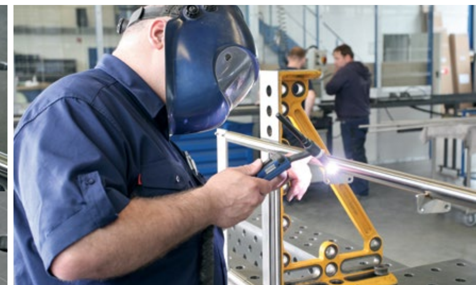
Positionierung der Stufenlaschen durch punktuell Anschweißen
