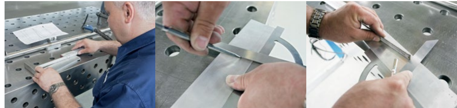
Sonderfall: Flexibilität ist gefragt, eine Schablone für die individuellen Sprossenabstände wird angefertigt.
