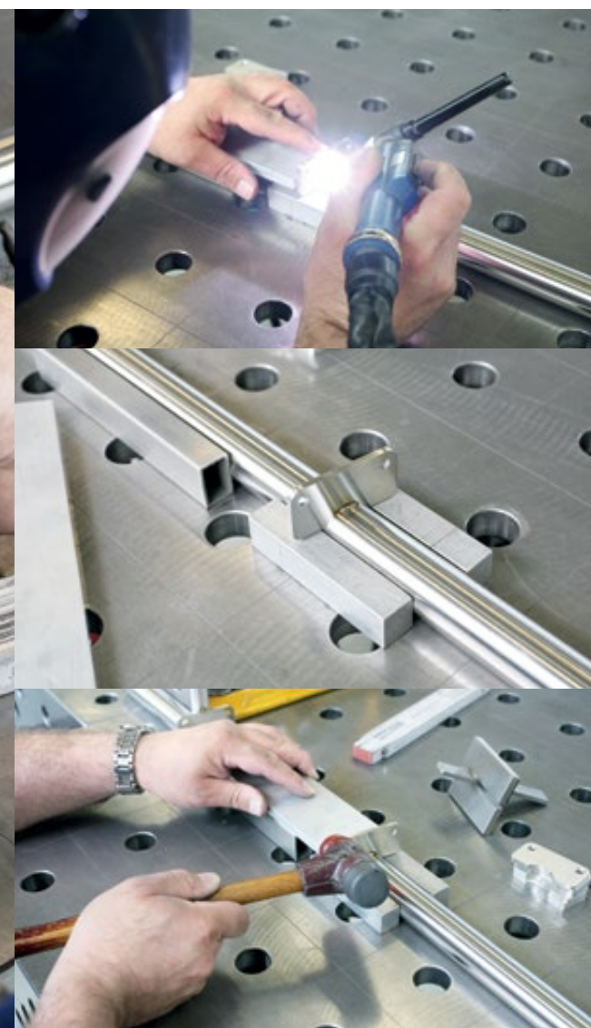
Positionierung der Stufenlaschen durch punktuell Anschweißen
