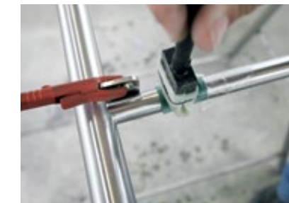
Nach dem Vliesen wird das MWE-Logo auf die Strebe geätzt.
