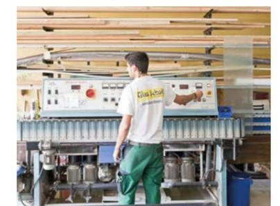
8-Spindel-Schleifautomat für schnelle Kantenbearbeitung
